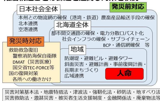
図-5 千島海溝南部の超巨大地震津波対策を考えるうえでの関連図。多様な階層に属する課題を階層的に複合させて解決していく取り組みが求められる。
