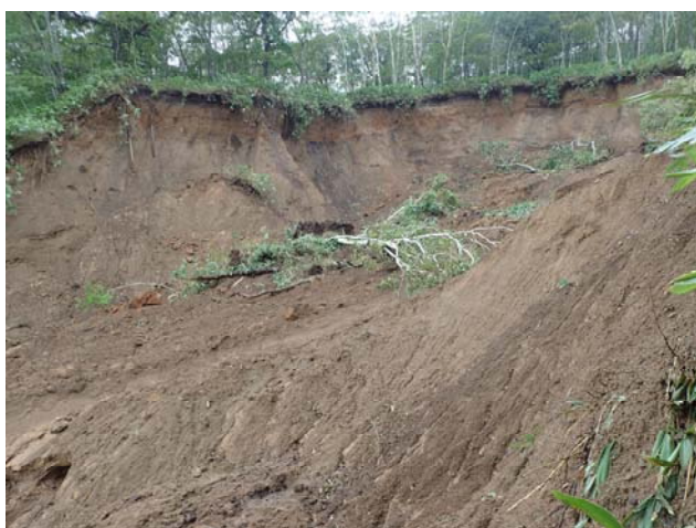
写真-2 崩壊源の斜面堆積物 淘汰の悪い角礫混じりシルト層
