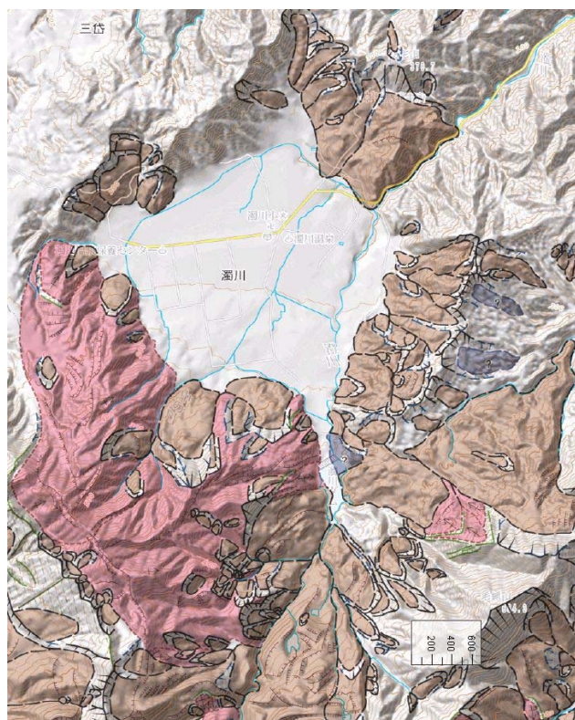
図 2 濁川カルデラ周辺の地すべり地形（カルデラの南西側に初期斜面的変形が広く分布している）
